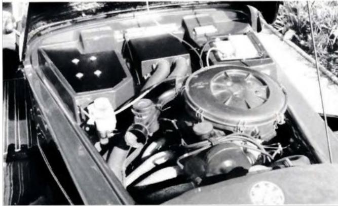
**Der Unterbodenbereich ist speziell auf den OHC-Motor zugeschnitten. Beachten Sie, wie der Pedalkasten versteckt ist und die Batterie über dem Fußraum des Beifahrers eingebaut ist.**
