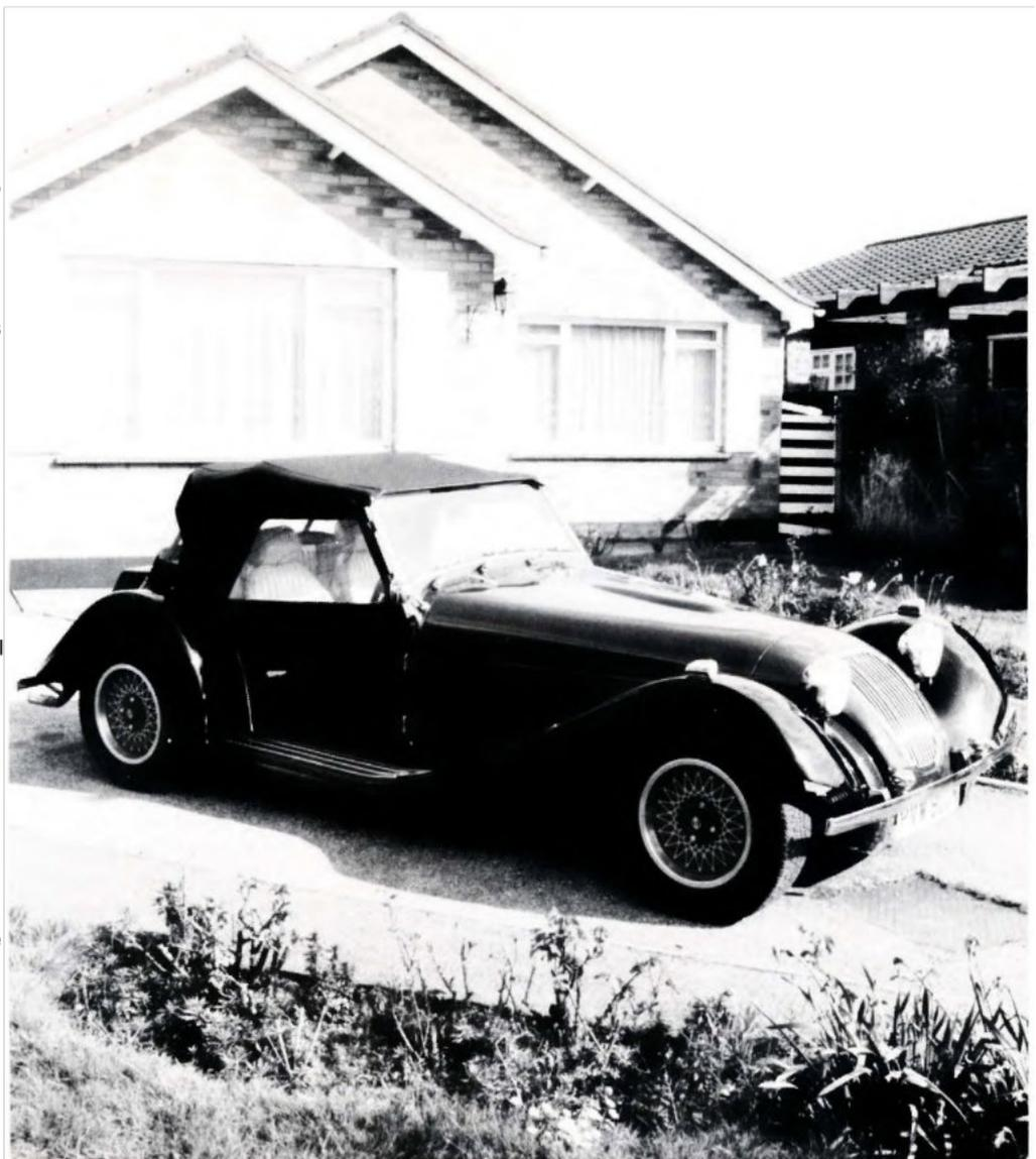
*Das Verdeck passt sich hervorragend an und erhält den Innenraum mit einer hohen Dachlinie, durch die Befestigung außerhalb der Armlehnen.*
